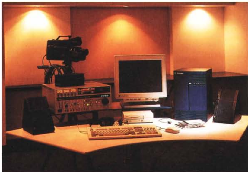
Un sistema per Desktop Video capace di Digital Media con Indigo. La «stampante laser» di un sistema DTV è... un videoregistratore.
