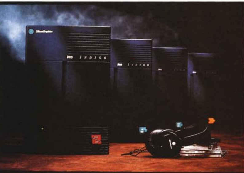
I modelli di Indigo con processore MIPS R4000 da 50 MHz.
