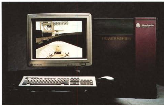
Simulazione in tempo reale con qualità fotografica dell'ingresso in un porto, possibile oggi con il RealityEngine di Silicon Graphics.
