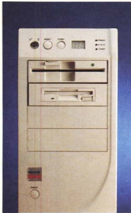
È possibile installare fino a quattro unità accessibili esternamente. Sul retro troviamo i vari connettori. ▶
