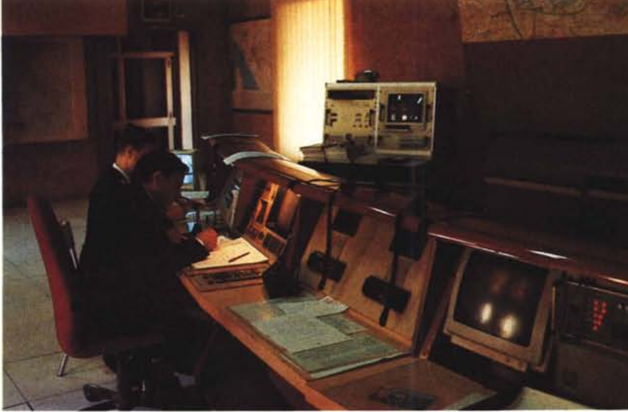
Uno scorcio della Centrale Operativa. L'apparato che si vede sullo sfondo riceve le immagini inviate da una telecamera installata su un elicottero.
