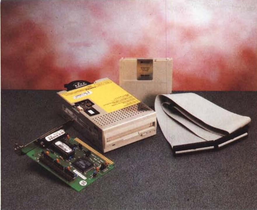
*Ricoh-RO3010i. A differenza del precedente modello quest'altra unità magneto-ottica della Ricoh (che risponde tra l'altro allo standard ANSI/ISO) è in versione interna, occupa un posto da 5,25 pollici ed ha una capacità massima di 128 Mbyte. In tal senso, oltre ad archivio, si propone a supporto ideale per i training aziendali a rappresentazione multimediale. Pianificando, nel tempo, vistane anche la praticità, potrebbe divenire la perfetta alternativa ai CD-ROM drive.*
