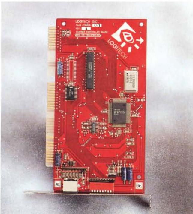
La parte elettronica è tutta qua. Di spicco un chip made Logitech di forma rettangolare con una piedinatura in-contabile.
