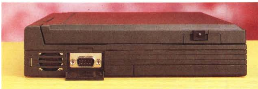
Sul lato sinistro troviamo la ventola d'aerazione e la seconda porta seriale.
