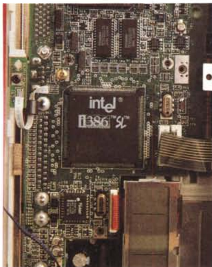
Il processore utilizzato è il «risparmioso» Intel 386SL.
