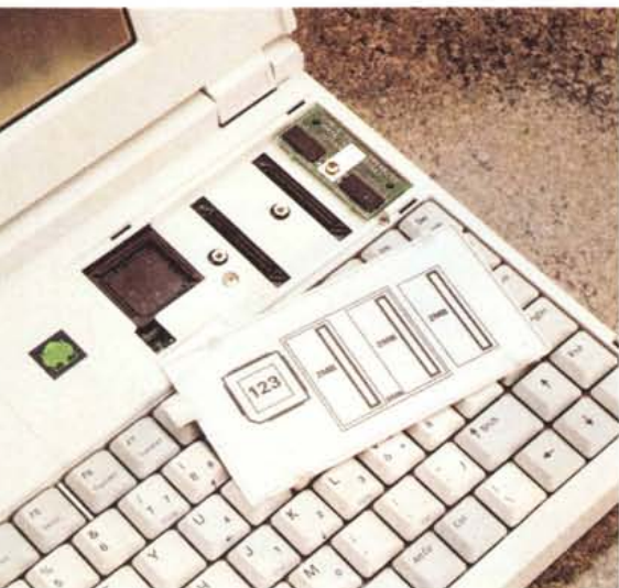
L'alloggiamento per l'espansione di memoria e il coprocessore matematico.
