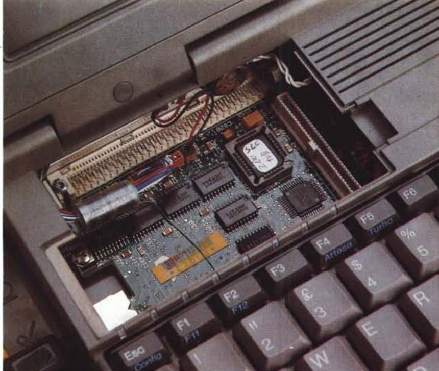
Particolare dello slot custom per l'inserimento della scheda modem/fax. Si noti il Bios specifico per il 486SLC.
