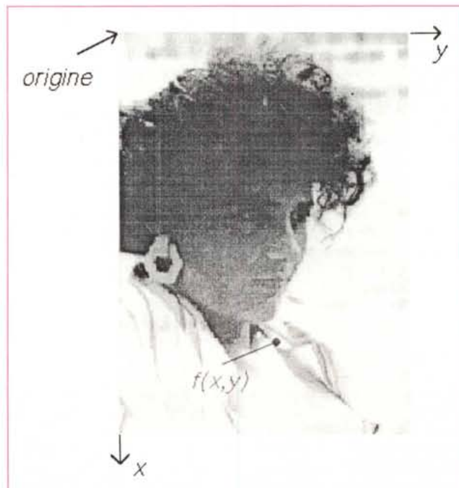
Figura 1 Convenzioni adottate per l'immagine. L'origine delle coordinate è nell'angolo in alto a sinistra.
