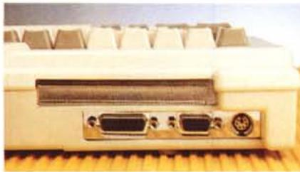
PCV-410P. Ecco il primo piano sulle connessioni poste all'uscita della scheda audio/video: il classico DB-15 della VGA, la porta-game e un connettore tipo S-Video per l'output videocomposito e i canali stereo dell'audio.
