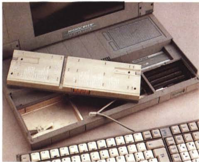
Alzando la tastiera ecco il pacco batterie ed il vano delle memorie.
