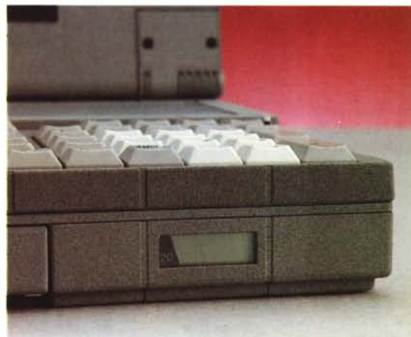
Tre particolari dell'elaboratore: la tastiera estraibile, la maniglia di trasporto e l'LCD che monitora lo stato degli accumulatori.
