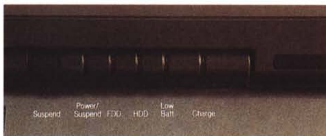
Particolare delle spie led di funzionamento.
