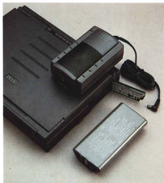
La batteria ricaricabile e l'alimentatore di serie.
