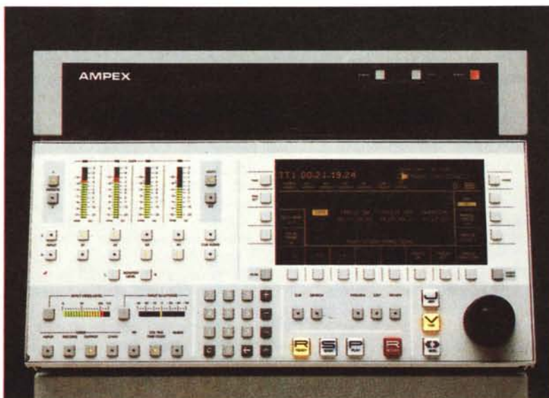
Una delle macchine D-2 attualmente in produzione; è il modello VPR-300 della AmpeX.
