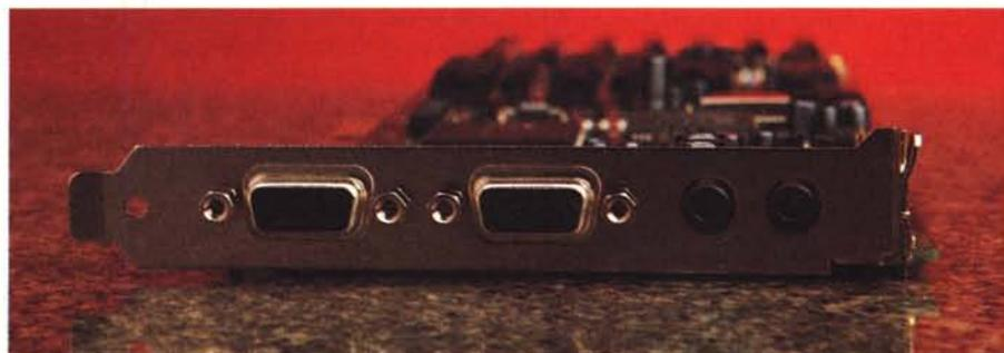
Primo piano sulla sbarra delle connessioni d'IN/OUTPUT della VideoBlaster. Dall'alto in basso, i due contatti RCA sono relativi all'ingresso microfonico ed all'uscita amplificata; quindi i due connettori DB-15 per la connessione d'Input delle sorgenti video e l'Output verso il monitor VGA.
