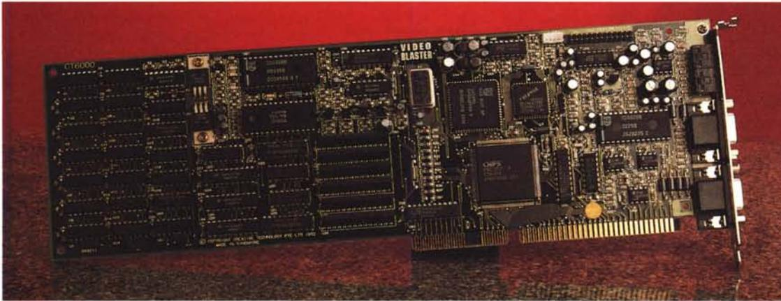
Primo piano sulla scheda. Si notino il gruppo della memoria VRAM del framebuffer più, in alto a destra, il connettore per il feature connector dell'adattore VGA già presente nel computer.
