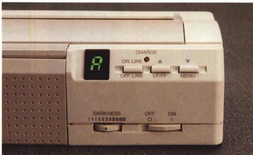
Il pannello di controllo (a grandezza naturale); in basso una veduta generale della stampante con lo speciale accumulatore rimosso dalla sua sede ed il cavo di interfaccia in dotazione, munito di connettore D subminiatura.
