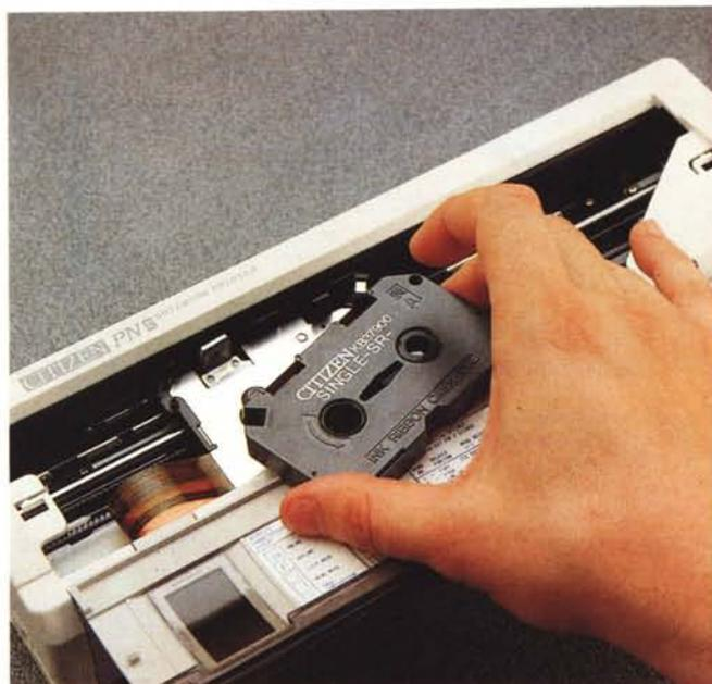
Due particolari su altrettanti elementi: i piccoli dip-switch per il controllo di alcune funzionalità e la cartuccia di nastro da inserire nell'apposito ricettacolo.
