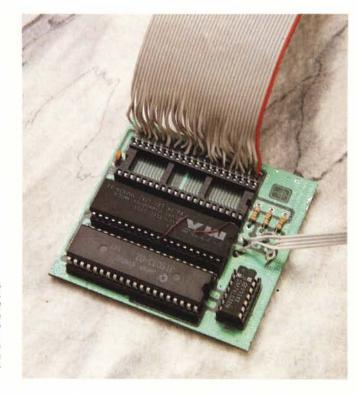
Con un saldatore a punta fine abbiamo realizzato tutte le saldature, che sono decine, visto che bisogna saldare i 3 zoccoli delle ROM, ognuno con due file infinite di piedini. Seguendo le schermate IFF fornite nel file PD non ci sono problemi a realizzare il tutto, anche il montaggio del cavo che va al deviatore e del cavo «prolunga» che connette la basetta alla piastra madre richiede solo una minima attenzione nel montaggio.
