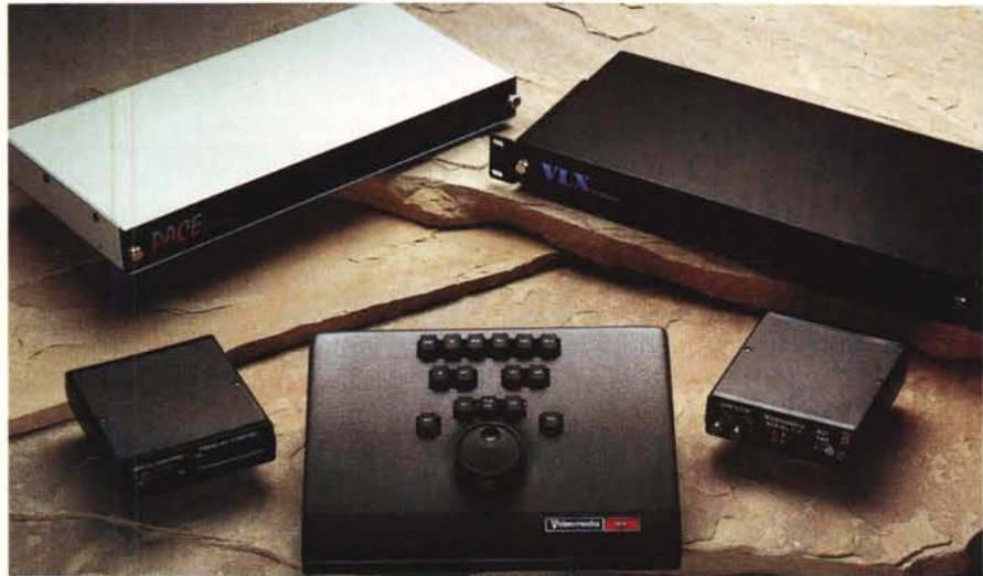
Diversi prodotti della Videomedia, con in alto due controller, il PACE Professional Animation Control Engine specifico per l'uso in single frame, il VLX che contiene due unità V-LAN configurabili come transmitter o receiver o entrambi, le due piccole unità stand-alone di prezzo più abbordabile ed al centro un editing controller dedicato.
