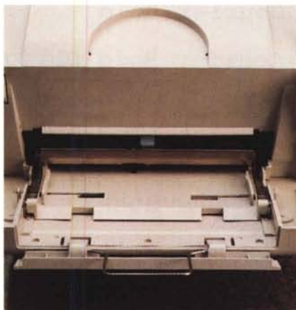
Il vassoio di alimentazione manuale della carta per fogli singoli e buste.
