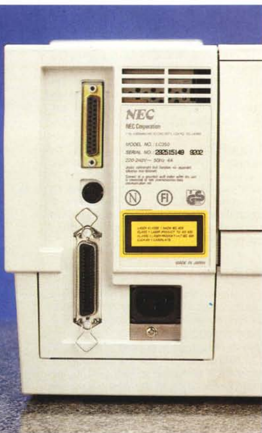
Sul retro della stampante sono ubicati tutti i connettori disponibili: interfacce ed alimentazione.
