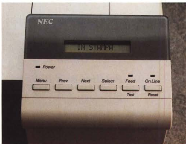
Il pannello di controllo completo di display «in lingua italiana» ed a fianco una vista laterale della periferica con il coperchio di accesso agli slot di espansione ribaltato per l'introduzione delle cartucce.
