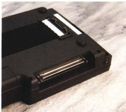
Il connettore di espansione e una delle slot per le Memory Card.
