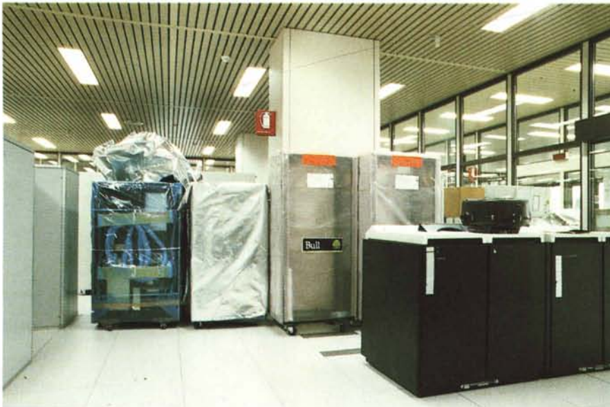
La sala delle 118 unità di memoria a disco, per 157 GB complessivi.
