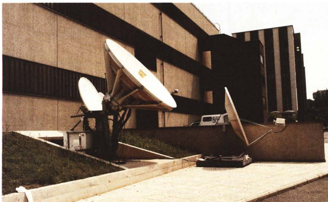
Antenne in prova per i collegamenti via satellite. Si cerca di ottenere la massima efficienza con dimensioni sempre più ridotte.
