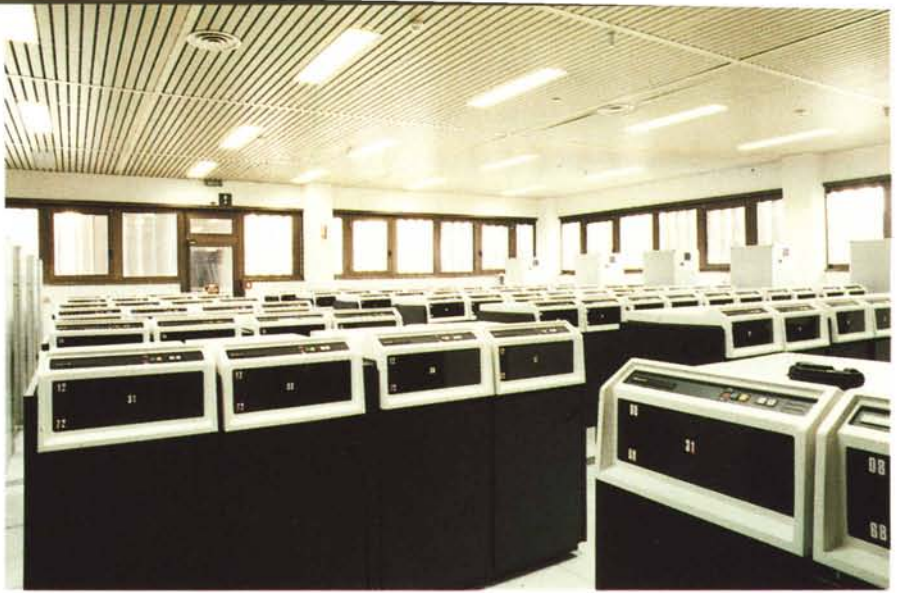
La sala delle 118 unità di memoria a disco, per 157 GB complessivi.
