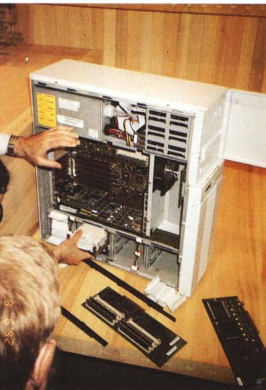
Piena modularità anche per gli Z-SERVER così come si vede dall'hard disk facilmente sostituibile.
