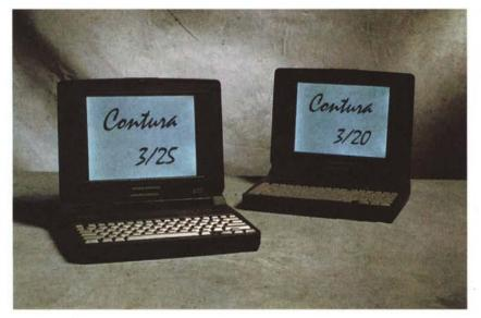
due modelli, con hard disk da 60 e 120 Mbyte, entrambi con memoria RAM da 4 Mbyte espandibile a 12 Mbyte e memoria cache da 64 Kbyte.
