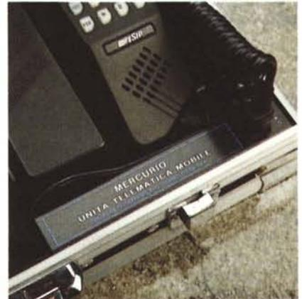
La parte ricetrasmittente dati sfrutta un modem integrato a standard V21 e V22, 1.200 e 2.400 Baud. Il software a corredo è quello standard a cui va aggiunto quello di comunicazione dati.
