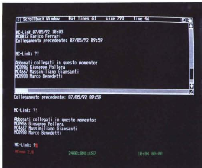
NCOMM, è attiva la finestra di scrollback, sono visibili i gadget di scorrimento del buffer.
