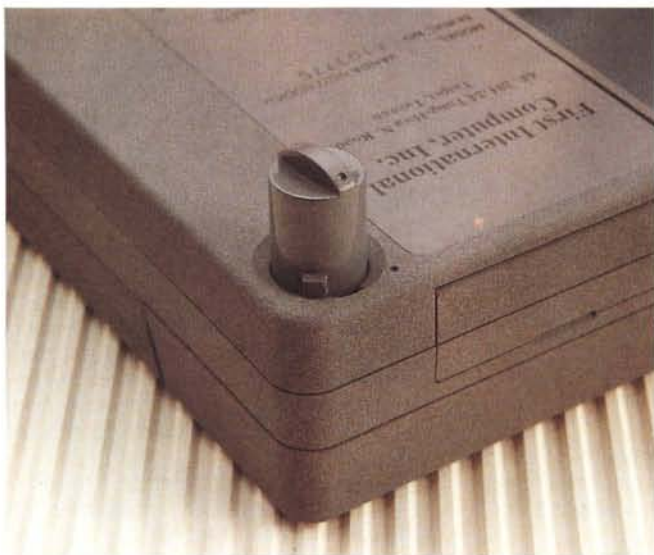
I piedini estraibili aumentano l'ergonomia della macchina. Nel vano porta batterie si nota il connettore per un bus esterno.
