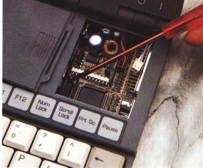
Il minuscolo alloggiamento per la scheda modem/fax.
