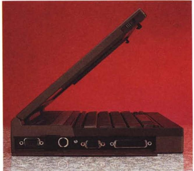
Le varie viste del Texas Instruments. Si noti nell'ordine il floppy, la presa per il KeyPad, il bus di espansione, la porta seriale, quella mouse, il video SVGA e la parallela Centronics.
