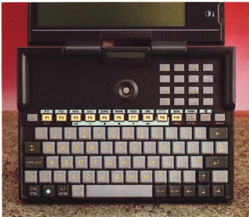
La tastiera (qui in versione inglese) è completa e consente un tocco molto preciso, nonostante le piccole dimensioni. Sotto il display di servizio c'è il pulsante di accensione. Il display vero e proprio, di qualità elevata, presenta uno spessore ridotto.
