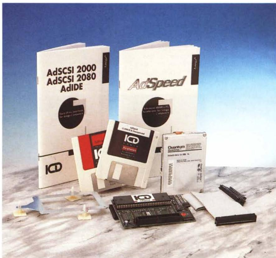
Un primissimo piano della scheda, molto ben fatta e senza ripensamenti, estremamente pulita. In alto è presente l'AdSpeed mentre il rimanente è l'AdIDE. Da notare anche la splendida meccanica Quantum Go-Drive da 2 pollici e mezzo e 40 MByte di capacità.
