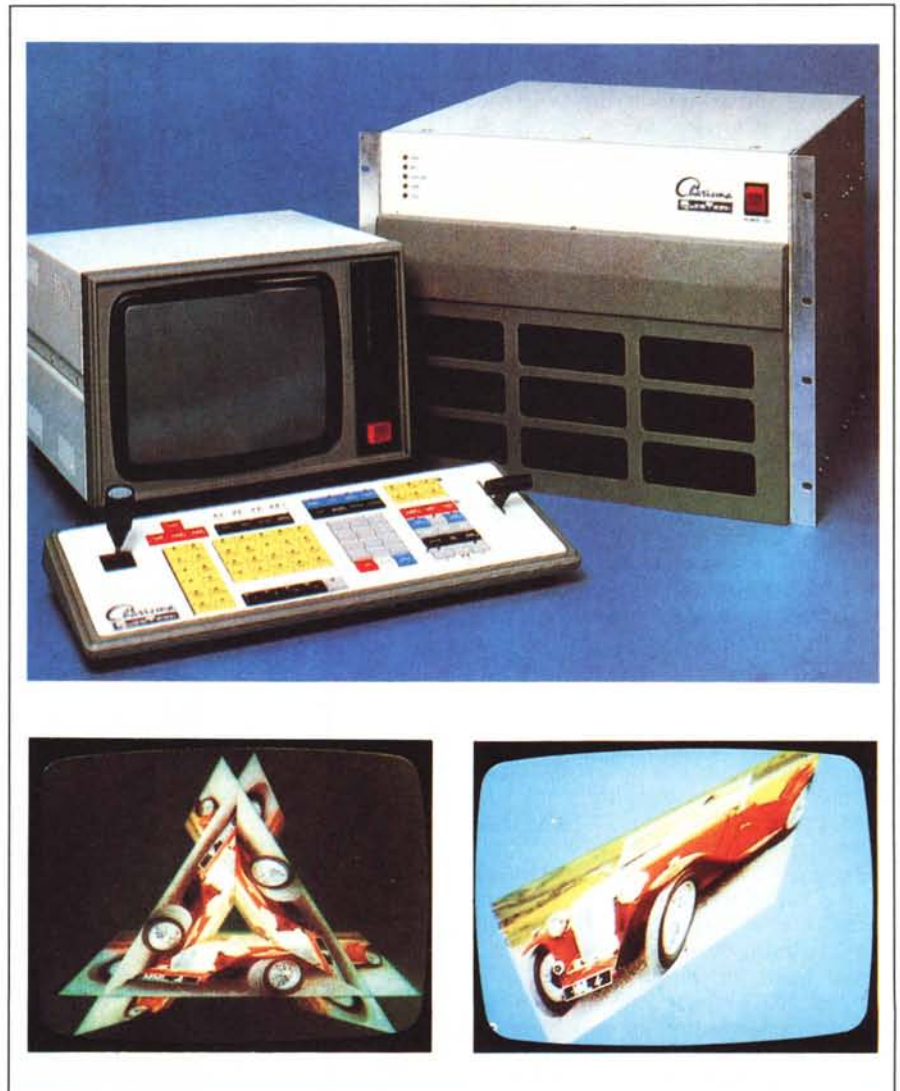
Figura 6 - Una unità DVE, tra le più complete, insieme due esempi delle sue capacità. È il sistema Charisma della QuesTech inglese. Lavora in 4:2:2 ed è anche abbastanza economica.
