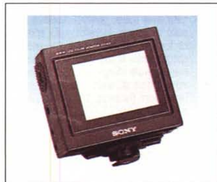
Il monitor LCD è inseribile sull'attacco a baionetta presente in ogni camcorder.
