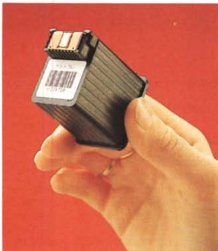
L'elemento di stampa contiene anche il serbatoio dell'inchiostro.
