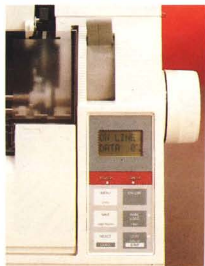
Il pannello di controllo della Citizen Swift 24e è semplice, ma altrettanto facile da utilizzare. Si noti anche la manopola di avanzamento manuale della carta e la leva di selezione dell'alimentazione (modulo continuo o foglio singolo).
