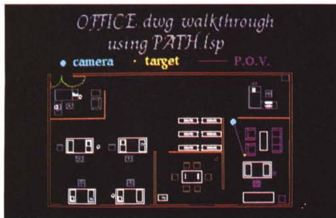
Figure 13, 14 - AutoDesk Multimedia Explorer - Realtà Virtuale. Progettiamo la disposizione del nuovo ufficio e poi facciamo una passeggiata «virtuale». Mi pare che le due figure diano un esempio evidente delle potenzialità dei nuovi mezzi grafici. Si progetta la disposizione di un ufficio a pareti mobili e poi si simula una passeggiatina «virtuale» al suo interno per valutare la correttezza e la accettabilità della disposizione studiata.
