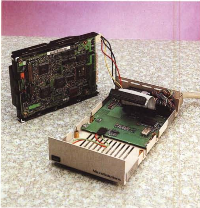
Elettronica interna ultra ridotta a confronto con quella a bordo dell'Hard Disk. Sopra la vista posteriore con l'uscita per la stampante.
