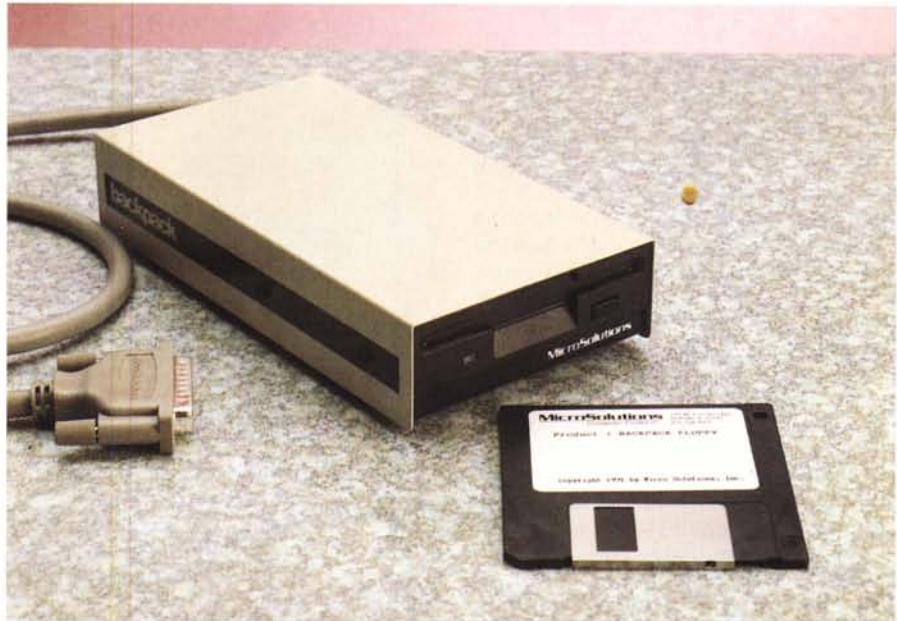
Ecco il floppy disk drive esterno con capacità di formattare a 2.88 Mbyte.
