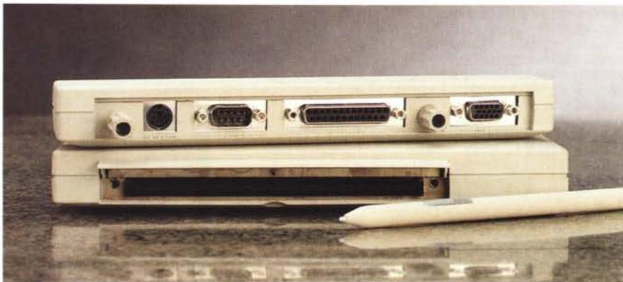
Vista laterale, si noti l'unità di estensione (RS232C, parallela, video, mouse e tastiera) e la penna.
