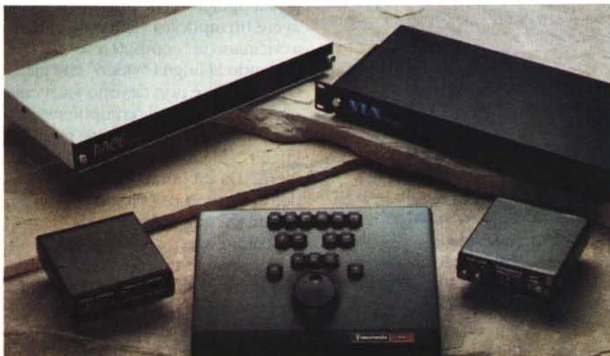
Sistema V-Lan (VideoMedia) per il controllo remoto di apparecchiature video a protocollo definibile via software per Macintosh II.
