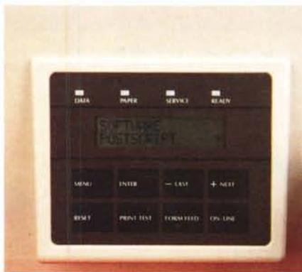
La OKI OL830 offre un comodo pannello completo di un display LCD che visualizza lo status operativo e facilita il settaggio dei parametri di funzionamento. Nella foto in basso è possibile vedere l'ingombro della stampante completa del cassetto di alimentazione e con il piano di raccolta della carta presente sul retro in condizione operativa.
