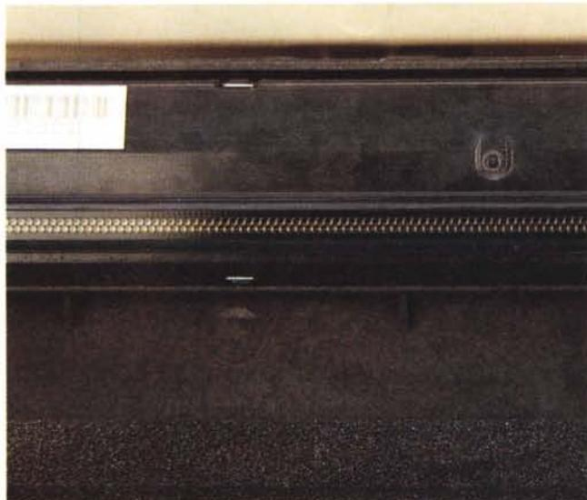
Qui sopra è possibile vedere un particolare del led array che consente di sensibilizzare il tamburo di stampa. A fianco la stampante con il coperchio sollevato mostra il cilindro contenente il toner; in basso una veduta generale della stampante con in vista tutti gli elementi sui quali è possibile agire.
