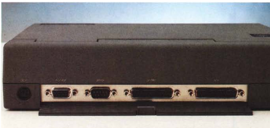
Sorpresa! Oltre alle connessioni «standard» troviamo anche una porta SCSI.
