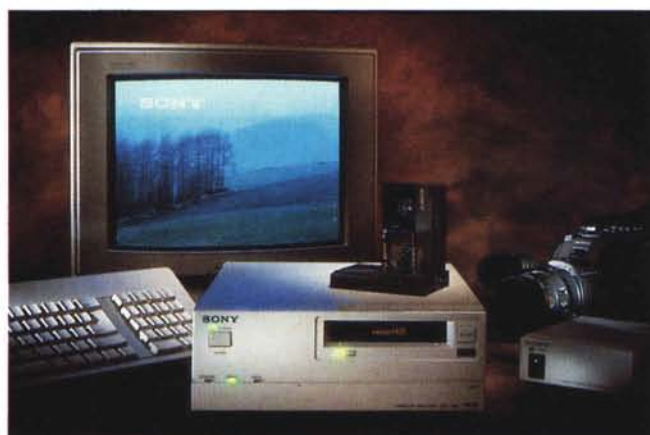
CVD-1000 Vdeck, il video drive Hi8mm Sony per computer con protocollo VISCA.
