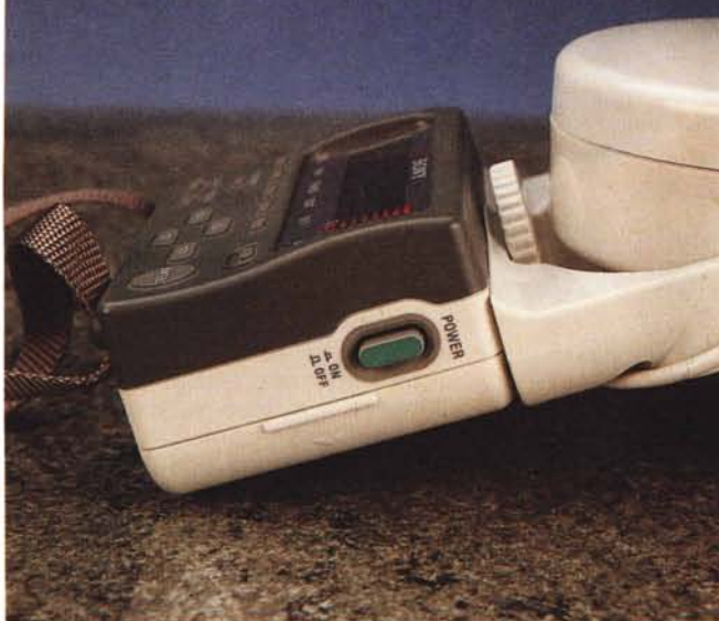
Il poderoso tasto di accensione. Nella foto forse non si nota ma un cappuccio di gomma protegge l'interno da intrusi come polvere o umidità.
