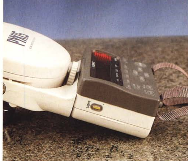
Piccolo pulsantino, non a scatto, che illumina il display. La luce dopo un certo lasso di tempo automaticamente si spegne. Attenzione: da non attivare con la sola alimentazione a batterie.
