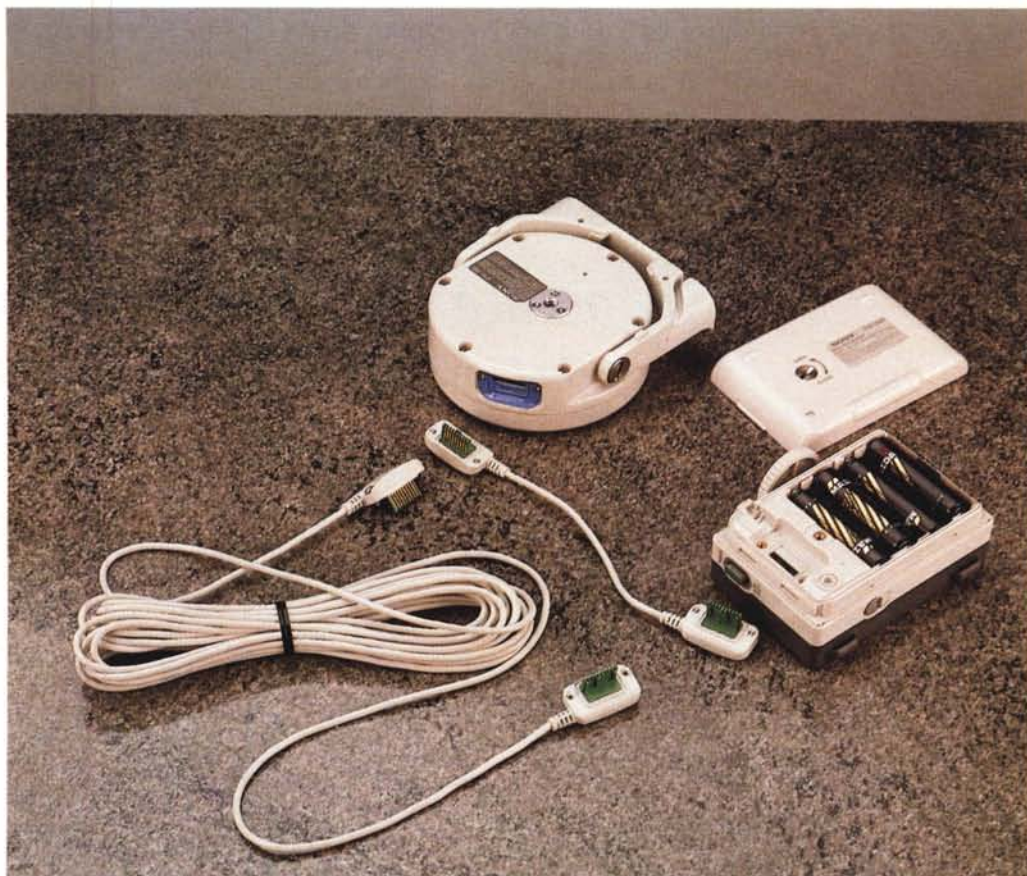
Il ricevitore Sony con il vano portabatteria aperto e la parte ricevente staccata dal corpo del decodificatore. Si noti sia il cavetto di prolunga che il connettore provvisto di viti di serraggio.
