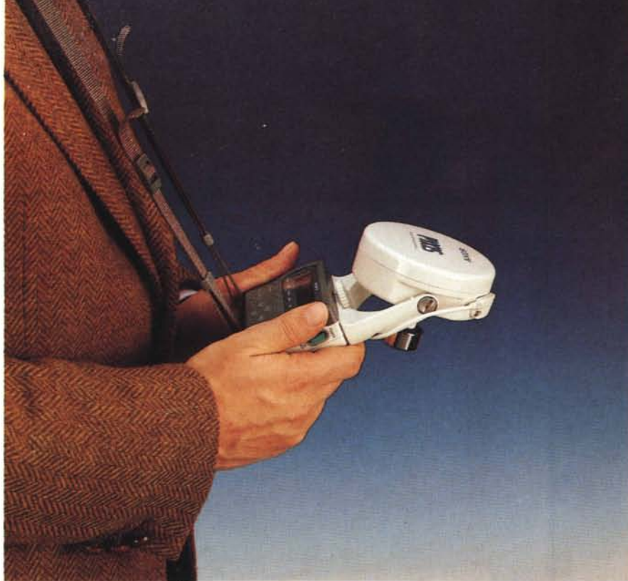
Portandoselo a spasso torna utile il contrappeso che tende a mantenere orizzontale il ricevitore (entro un angolo di 10 gradi).
