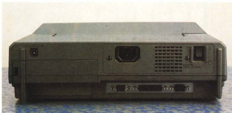
Il retro della macchina: notare la presa per la corrente di rete (l'alimentatore caricabatterie è incorporato).
