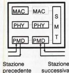
Figura 4 - La stazione DAS (Dual Attachment Station) può essere collegata direttamente sia all'anello principale che a quello secondario. Utilizza due cavi duplex ognuno dei quali collega la stazione con una delle adiacenti.
