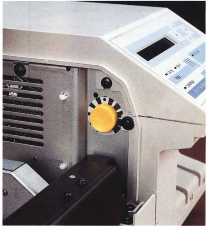
La leva sul lato sinistro del cassetto di alimentazione consente di escludere l'alimentazione automatica per l'introduzione manuale dei fogli. Aprendo il coperchio superiore si accede al nottolino che controlla la densità di stampa.
