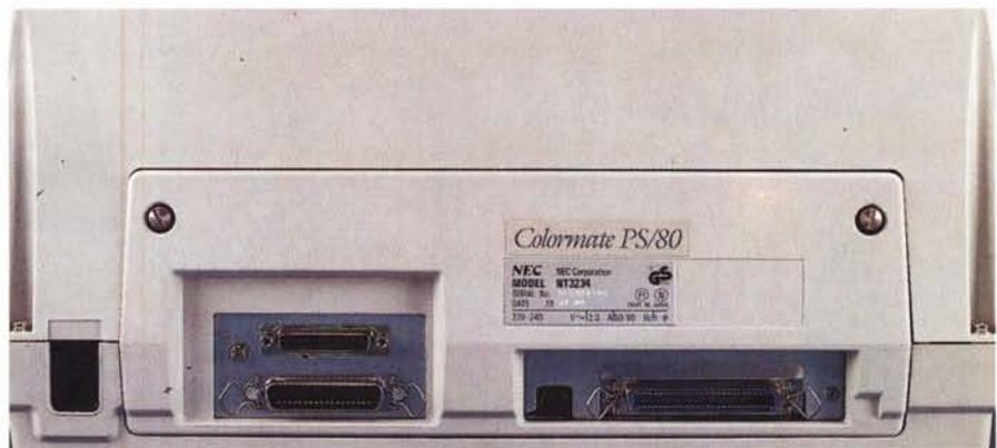
La dotazione di connettori comprende: parallela Centronics, seriale RS232, RS422/AppleTalk e SCSI per il collegamento di un hard disk con funzioni di downloading dei font.
