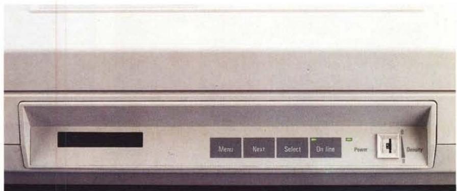
Il pannello operativo della Colormate incorpora anche un display LCD ed un commutatore per il controllo della densità di stampa.
