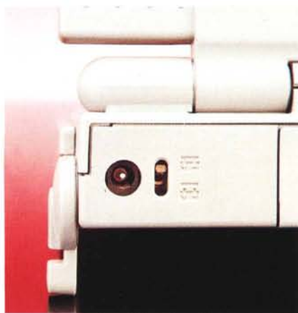
Accanto all'ingresso per l'alimentatore c'è un interruttore per scollegare elettricamente la batteria interna in caso di lunghi periodi di inattività.
