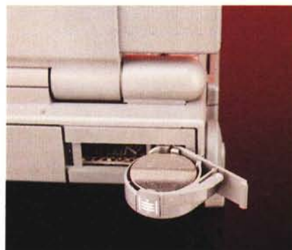
A batteria scarica la conservazione dei dati in memoria è assicurata da un ulteriore sistema di alimentazione formato da tre pile al litio.
