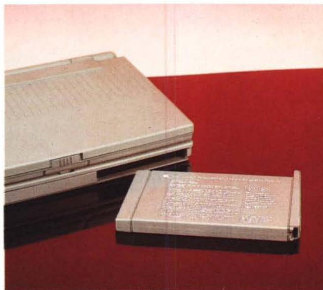
La batteria ricaricabile è accessibile (quindi facilmente sostituibile) frontalmente agendo sullo sblocco a slitta.
