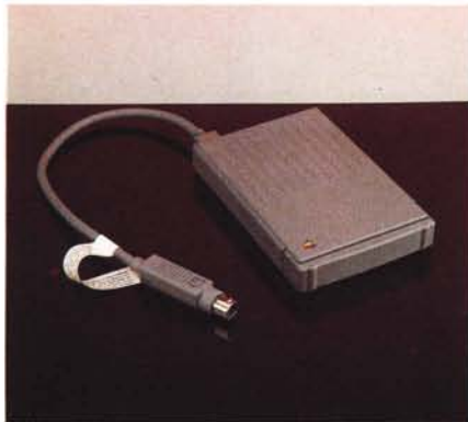
Il drive esterno 1.44 MB fornito a corredo con la macchina. Come sempre legge dischi Mac e MS-DOS.
