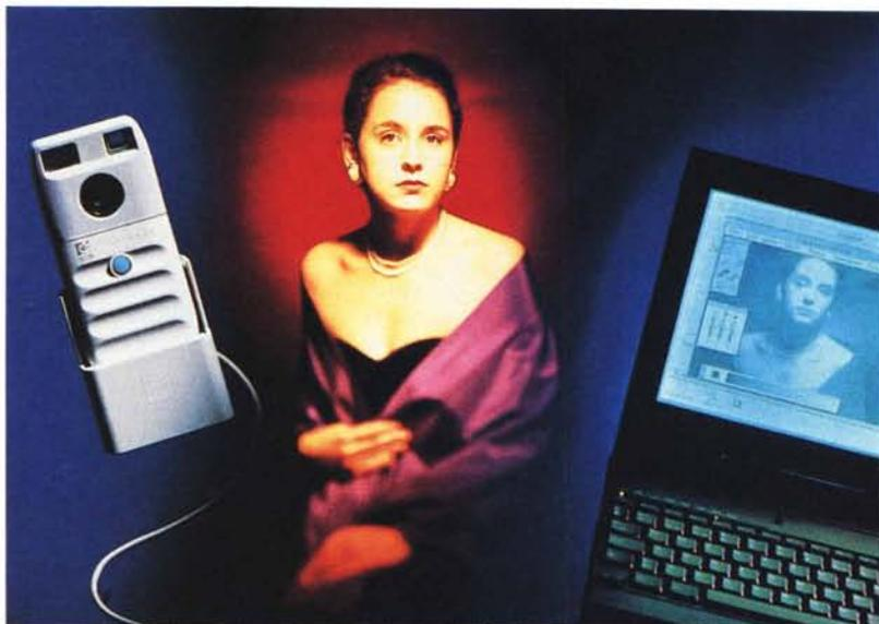
**P**otrebbe essere definita l'ultima trovata della Logitech: FotoMan, la prima macchina fotografica completamente a stato solido e digitale. Il prodotto nasce da un accordo di OEM tra la Logitech stessa e l'americana Dycam Inc. a cui però l'industria delle periferiche di puntamento porta come dote il software di gestione delle immagini «catturate»: FotoTouch.
