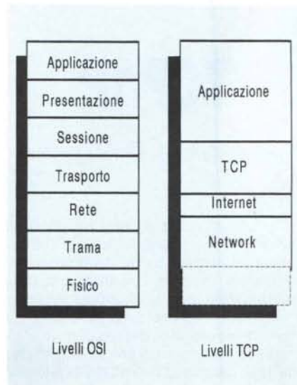
Figura 2 - Modello architetturale del TCP/IP. I quattro livelli sono comparati con la stack OSI.
