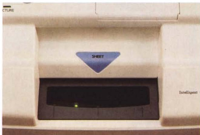
Nella zona di lettura sono presenti i led luminosi che indicano la reale finestra di scansione; nella parte superiore un coperchio permette l'accesso al supporto della lama di taglio, facilmente estraibile per la sostituzione.
