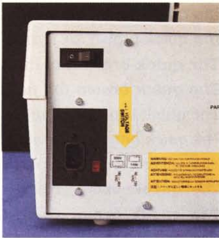
Il connettore di alimentazione ed il relativo interruttore completati dalla presenza di un cambiaterensione.
